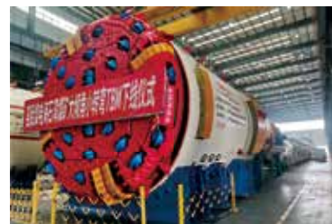
TBM(盾构)掘进机准备入井投用
