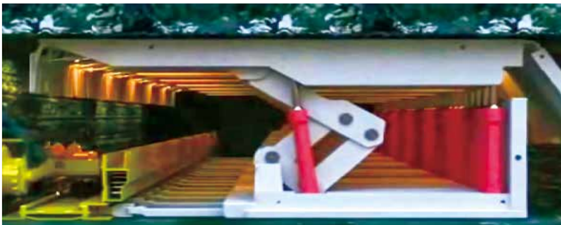
井下工作面膏体充填开采现场模拟效果图
