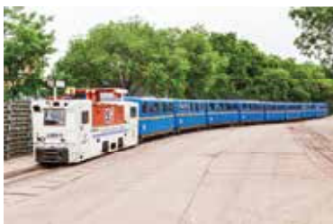
CTL12/6GP 型智能化无人驾驶防爆电机车
