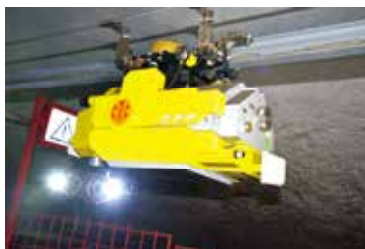
井下巡检机器人
